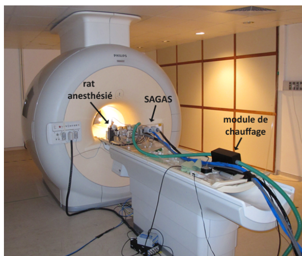
FIGURE 6.2.1 : Installation du dispositif expérimental sur le lit de l'IRM. Un module de chauffage par ventilation d'air chaud (Heater system, SA Instruments, Inc., États-Unis) a été ajouté pour le maintien en température de l'animal.
