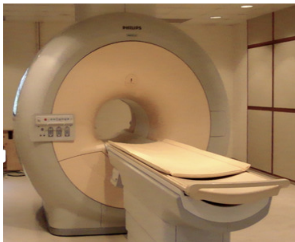
FIGURE 4.2.1 : Imageur Philips Achieva 1,5 T installé au CIERM.
